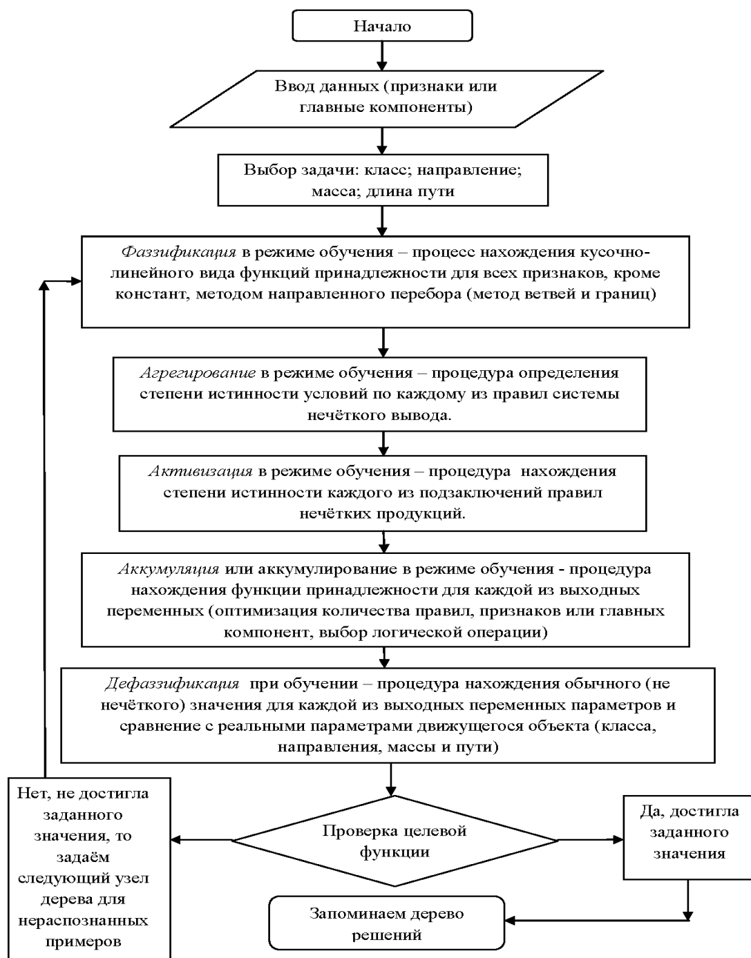
Рис. 10. Блок-схема алгоритма построения нечёткого дерева решений
