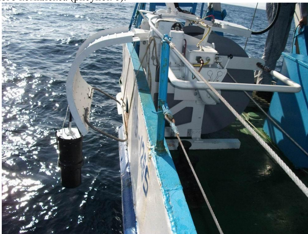
Рисунок 6. Лебедка с установленным слипом на борту НИС «Профессор Насонов»
