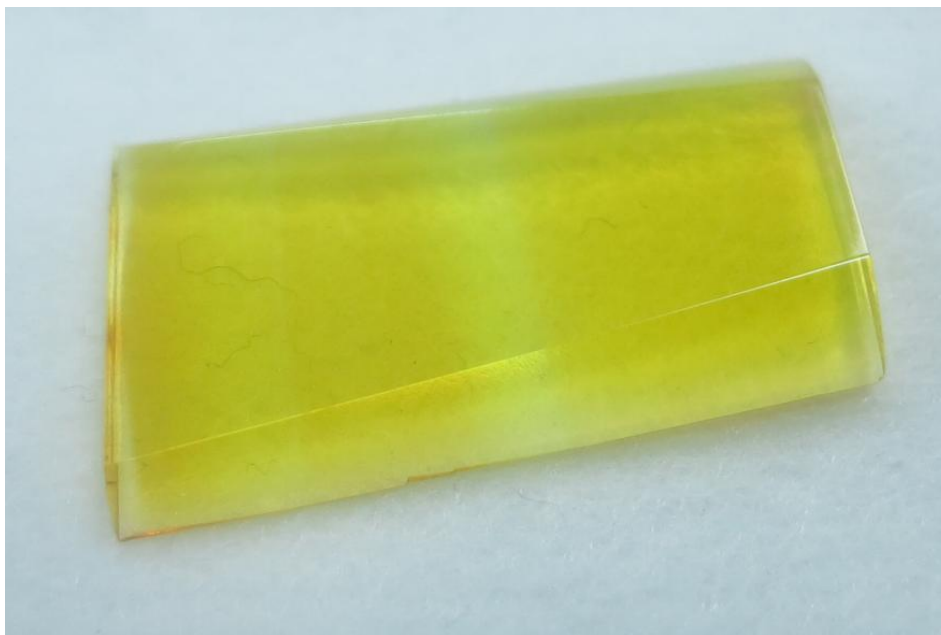
Рис.8. Образец ПММА, допированный соединениями \beta -дикетонатов дифторида бора
