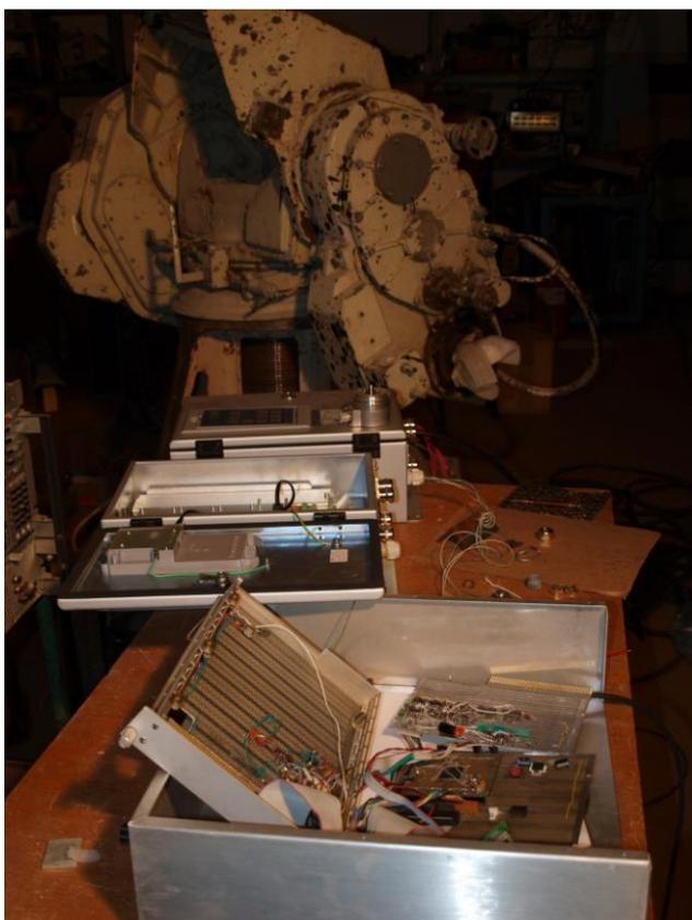
Рисунок 6.1.2. Макетный стенд модернизированной системы сопровождения, включающий в себя систему управления (на переднем плане корпус с тремя платами), далее два частотных преобразователя VFX40-004 (первый с открытой крышкой) и на заднем плане собственно антенная колонка. На корпусе второго преобразователя виден датчик ROQ437.
