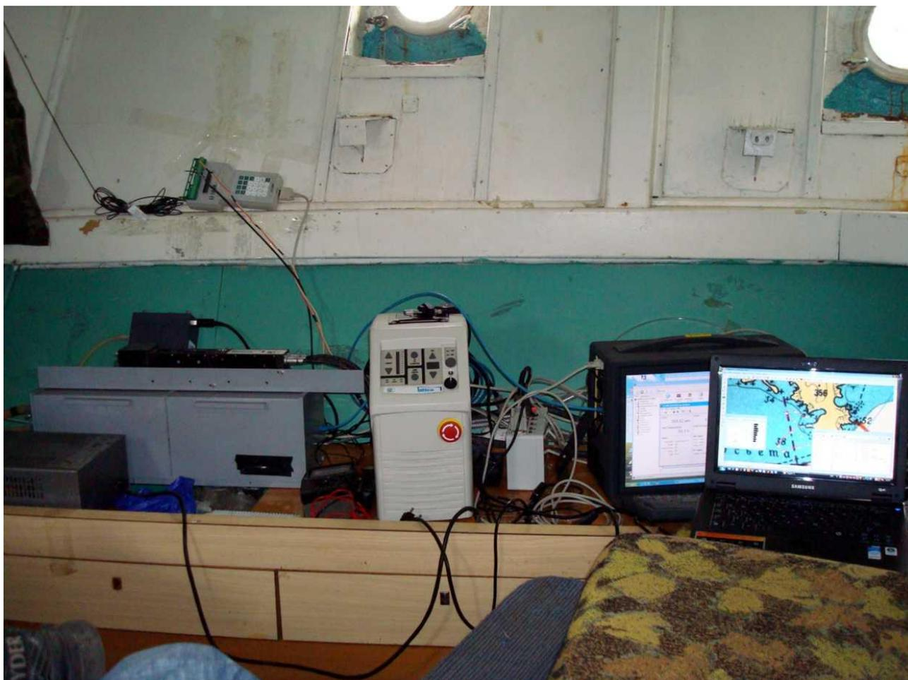
Рисунок 3.3.2 Расположение лазерного флуориметра на борту судна «Малахит»
