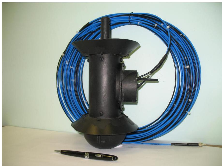
Рисунок 3.3.6 Погружаемый модуль флуориметра
