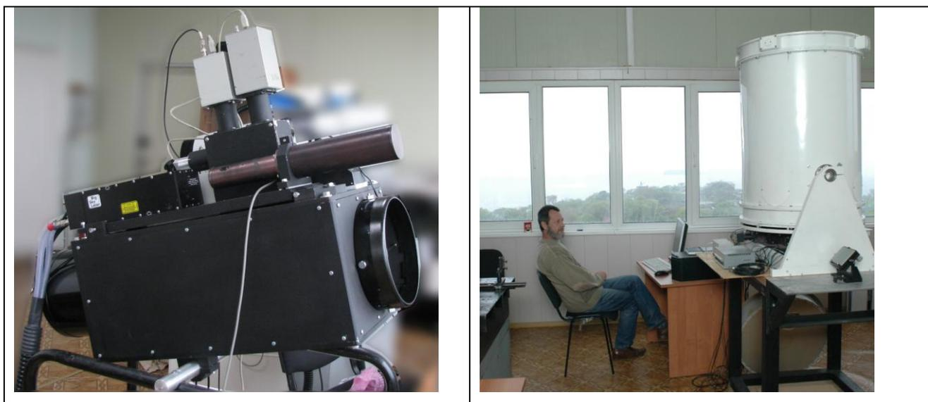
Рисунок 6.2.1 лидарный комплекс УСУ ЛаМИ: а – аэрозольный лидар; б – озонный лидар.
