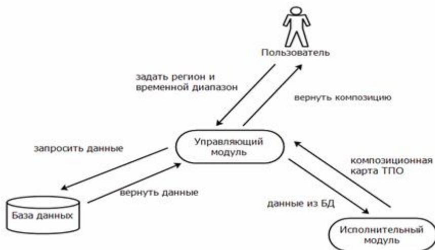
Рисунок 3.7.2.1. Общая схема работы системы построения композиций ТПО
