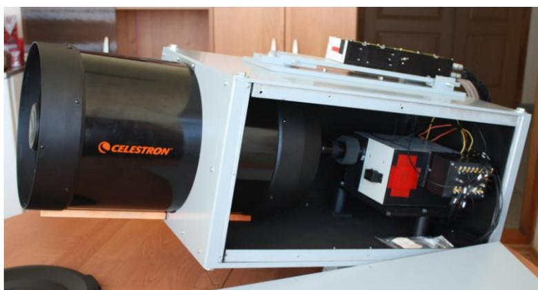
Рисунок 3.3.17 а - Блок-схема флуоресцентного лидара; б – фотография лидара.
