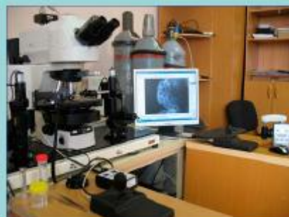
Приборный комплекс для исследования объектов методом полного внутреннего отражения Nikon Eclipse 90i с системой двух наноманипуляторов для трехмерного перемещения объектов
