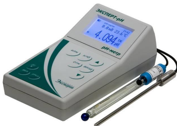
Рисунок 7.2 - рН-метр модели "Эксперт-рН", выпускаемый российской компанией "Эконикс-Эксперт" (С.-Петербург). Является одной из лучших моделей, применяемой в пи-
