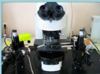
Приборный комплекс для исследования объектов методом полного внутреннего отражения Nikon Eclipse 90i с системой двух наноманипуляторов для трехмерного перемещения объектов
