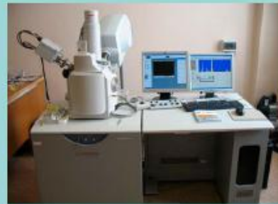
Сканирующий электронный микроскоп HITACHI S-3400N с EDS и WDS детекторами
