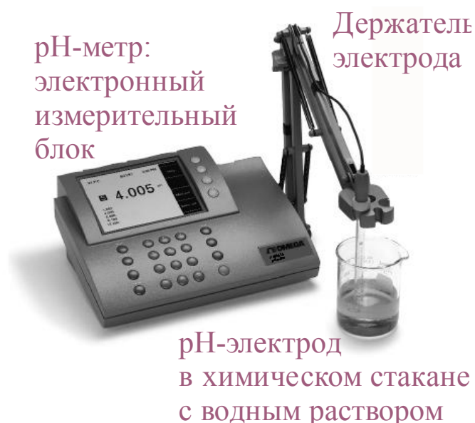
Рисунок 7.1 - Современный рН-метр в комплекте с комбинированным рН-электродом и держателем. Производится компанией Orion (США).
