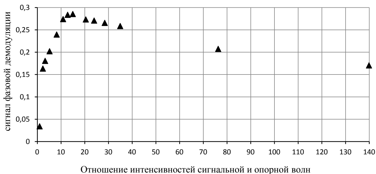
Рисунок 2.5 – Зависимость величины сигнала фазовой демодуляции от отношения интенсивностей опорной и сигнальной волн
