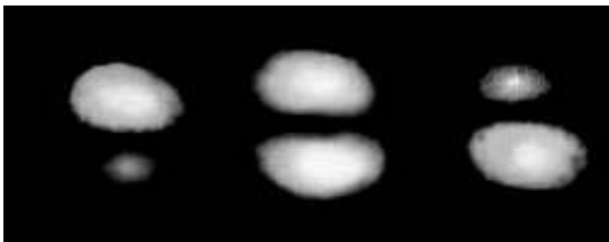
Рисунок 1.2 - Картина интерференции двух линейно-поляризованных (LP) мод низшего порядка, формирующиеся одноволоконным многомодовым интерферометром, работающим в режиме возбуждения малого числа мод
