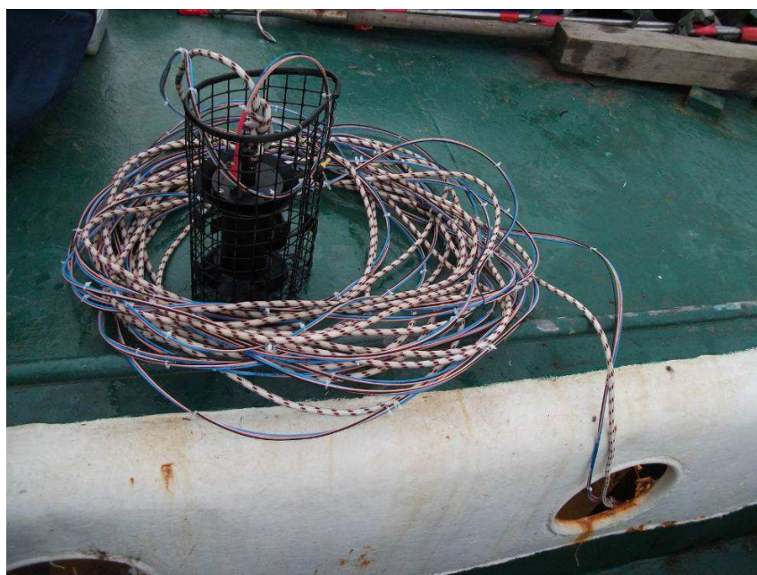
Рисунок 2.15. Погружаемый измерительный модуль и оптоволоконный кабель-трос
