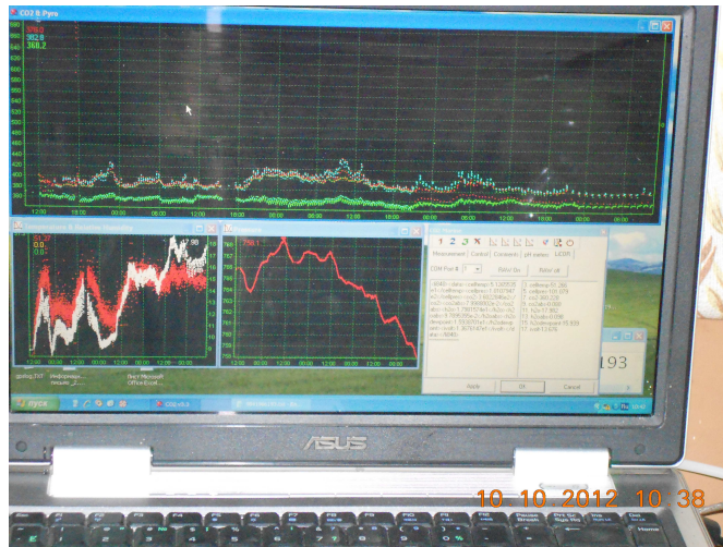
Рис. 3.10 Временная развертка содержания \text{CO}_2 над и под морской поверхностью
