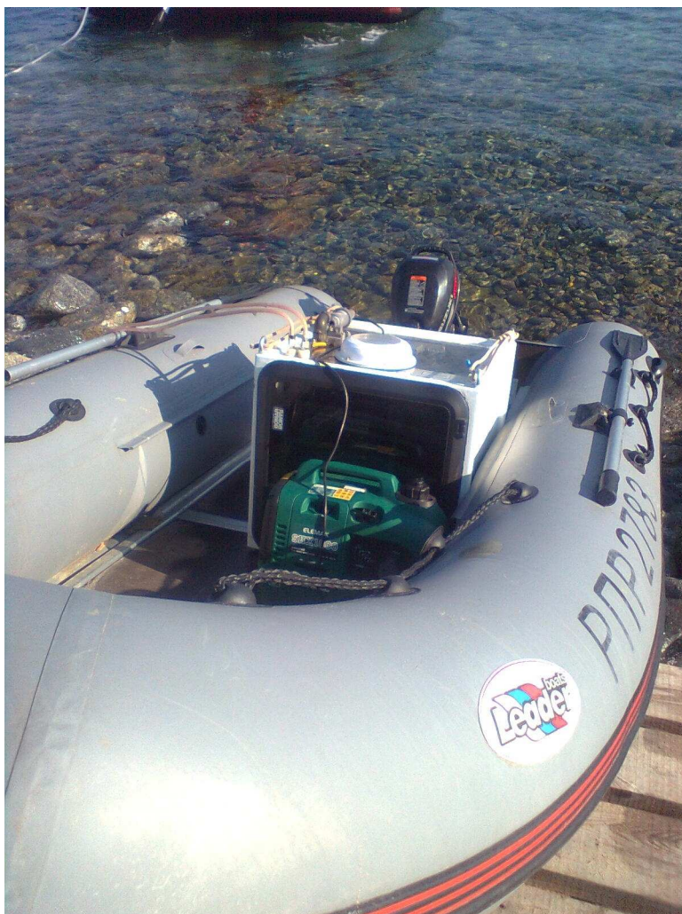
Рисунок 2.12 Расположение мобильного модуля ДЛФ на борту четырехместной моторной лодки.
