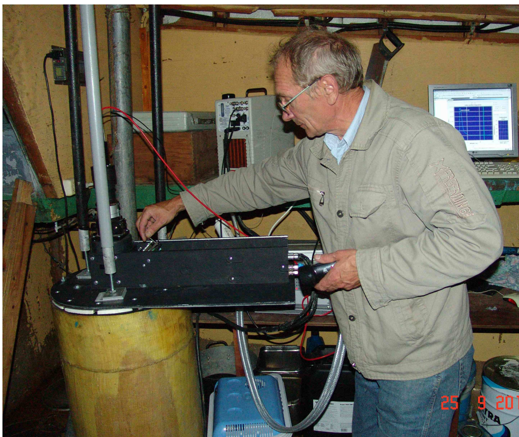
Рисунок 2.18. Процесс лидарного зондирования верхнего слоя океана.
