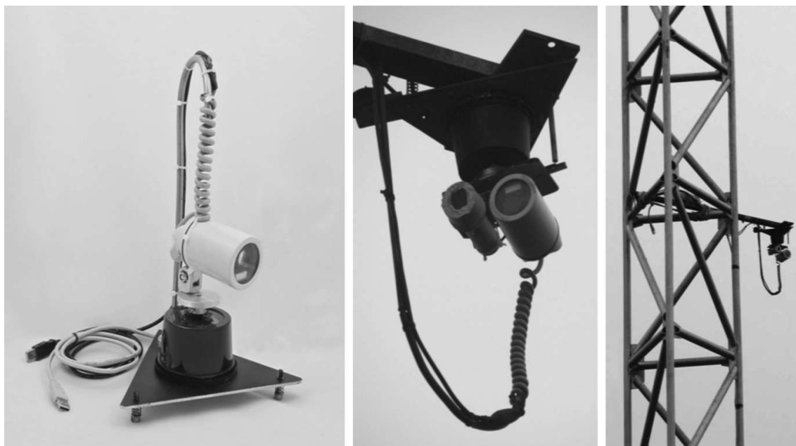
Рис. 2.19. Внешний вид видеосистемы и ее расположение на морской экспериментальной базе ТОИ в бухте Витязь (размер стороны панели 22 см; высота расположения видеосистемы на вышке 92 м над уровнем моря).
