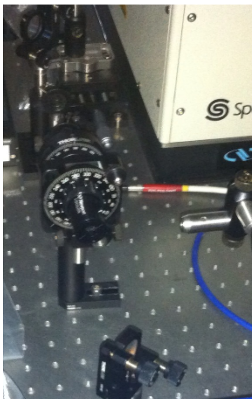
Рисунок 7.2. Фотография части установки плавной для регулировки и контроля энергии импульсов.
