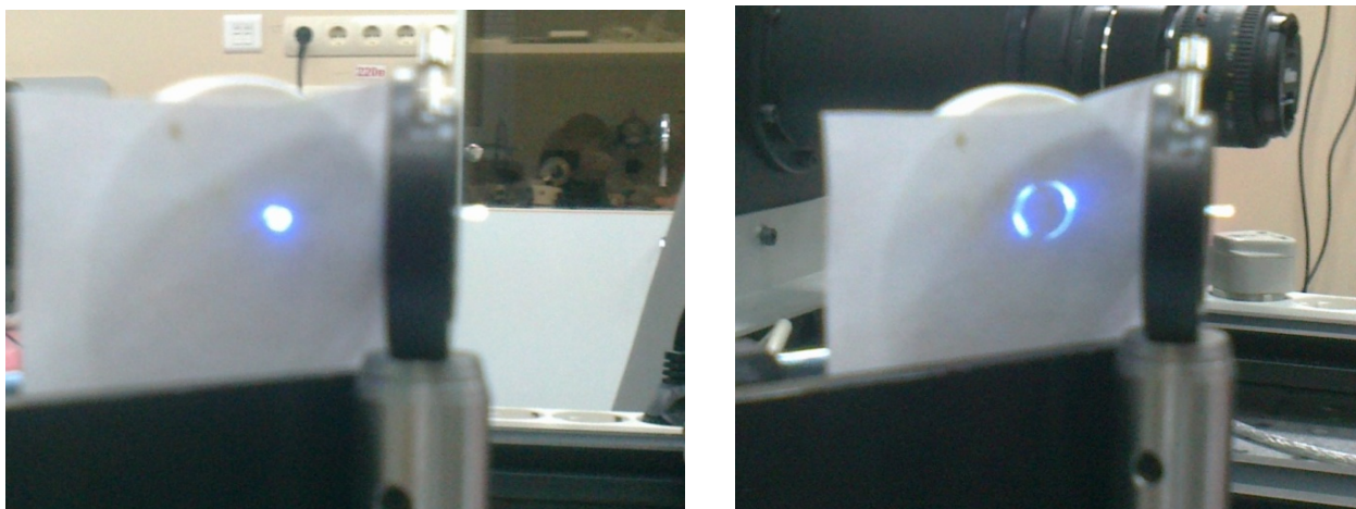
Рисунок 10.7. Фотографии эксперимента при разных углах вхождения излучения 400 нм, слева – угол вхождения 0^{\circ} ; справа - 10^{\circ} .
