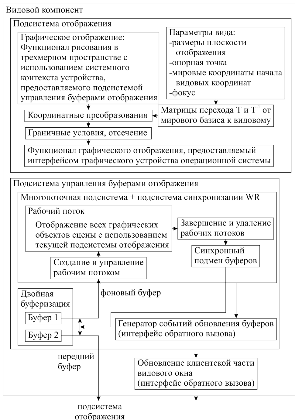
Рис. 5. Компонент графической системы, реализующий видовой объект
