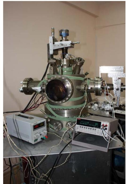
Рисунок 1.11 – (а) Схема экспериментальной установки RIBER DEL-300: 1 – манипулятор, 2 – основная камера, 3 – исследуемый образец, 4 – четырёхзондовая приставка для электрических измерений. (б) Фотография установки.
