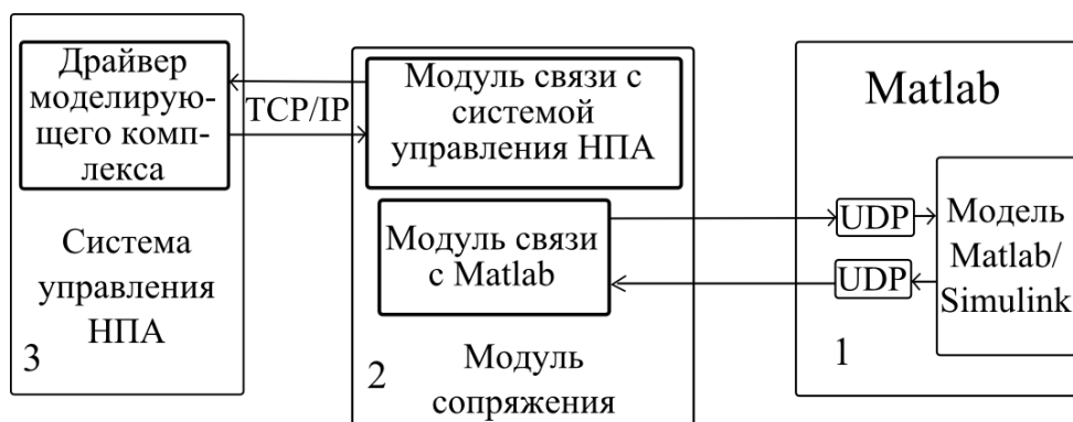
Рис. 19. Обобщенная схема сопряжения среды Matlab с СУ НПА
