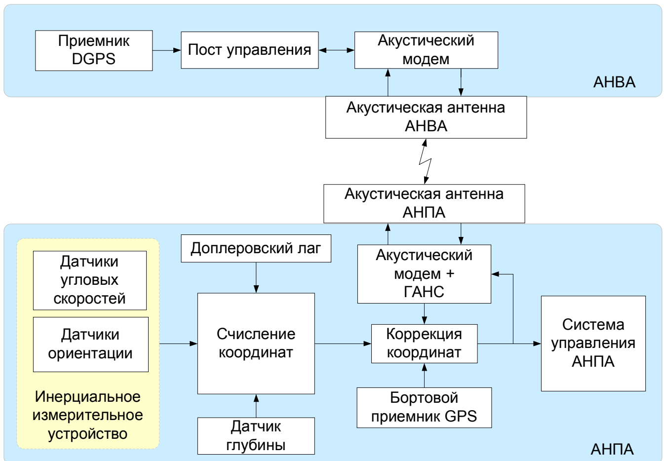
Рис. 6. Структура комплексированной навигационной системы АНПА «МАРК».
