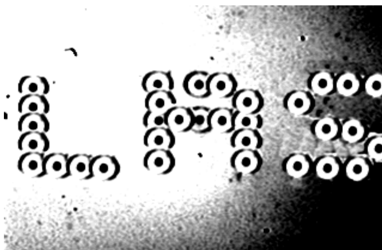
Рисунок 10.6. Надпись «LAS» выполненная кратерами диаметром ~25 мкм на поверхности боросиликатного стекла.
