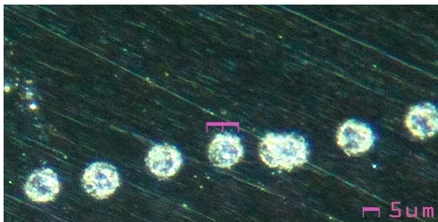
Рисунок 10.12. Кратеры на поверхности полированного кремния. Импульс 1,3 мкДж, частота повторения 4 Гц.
